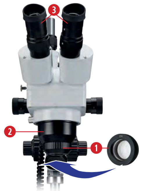
Abb. 13: Anbringen des Zusatzobjektivs.
