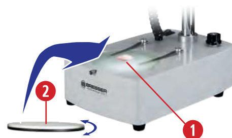
Abb. 4: Austausch der Objektplatte.
