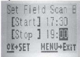
Schritt 5 (optional): Stellen Sie den Start- & Stoppzeitpunkt für Field Scan "B" ein
