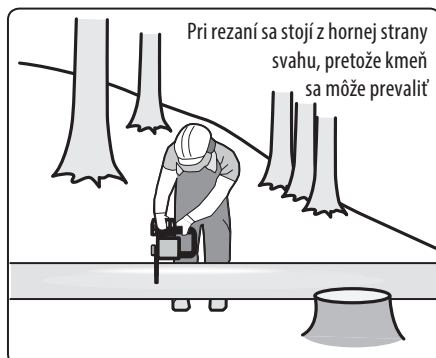
Priečne rezanie/skracovanie kmeňa, obr. 16
