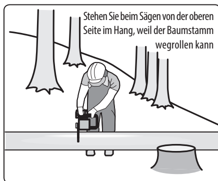
Querschneiden/-ablängen von Stämmen, Abb. 16
