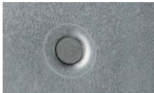
RESULTADO AL PONER UN REMACHE AUTOPERFORANTE
