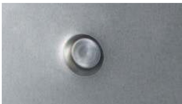
RÉSULTAT DE POSE D'UN RIVET AUTO-PERÇANT
