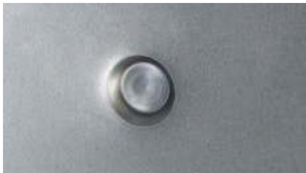
РЕЗУЛЬТАТ УСТАНОВКИ САМОПРОНИКАЮЩЕЙ ЗАКЛЕПКИ
