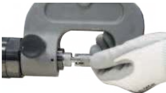
Привинтите насадку, идущую в комплекте с плечом.
