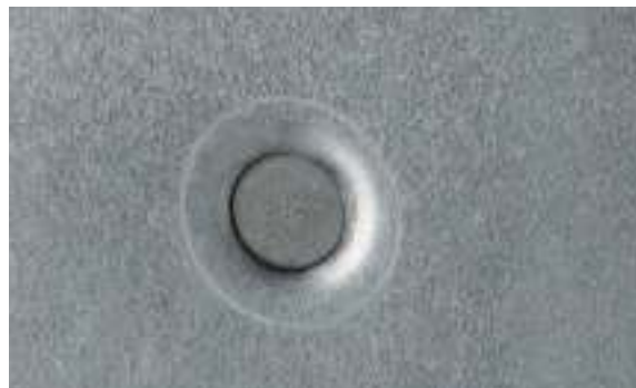
AFBEELDING PONSNAGEL VERBINDING VOOR- EN ACHTER-ZIJDE
