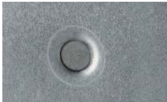
РЕЗУЛЬТАТ УСТАНОВКИ САМОПРОНИКАЮЩЕЙ ЗАКЛЕПКИ
