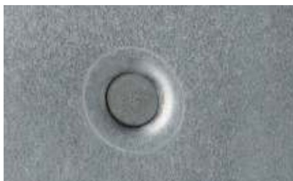
RÉSULTAT DE POSE D'UN RIVET AUTO-PERÇANT
