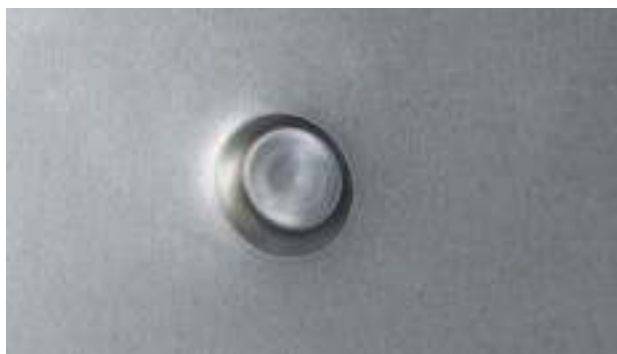
RESULTADO AL PONER UN REMACHE AUTOPERFORANTE
