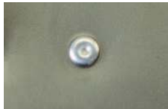
ERGEBNIS DER APPLIKATION EINES FLIESSFORMNIETES
