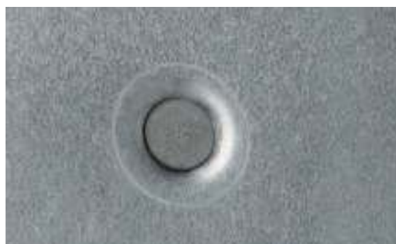
RISULTATO DELLA POSA DI UN RIVETTO AUTO-PERFORANTE
