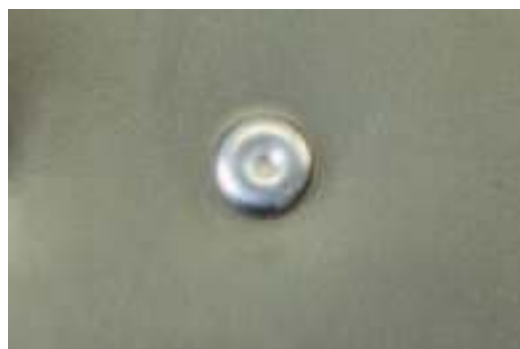
RÉSULTAT DE POSE D'UN RIVET FLOW-FORM
