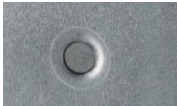
ABBILDUNG STANZNIETVERBINDUNG VORDER- U. RÜCKSEITE
