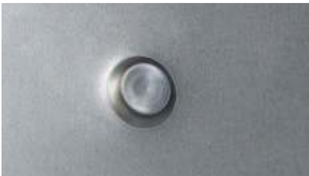
ABBILDUNG STANZNIETVERBINDUNG VORDER- U. RÜCKSEITE
