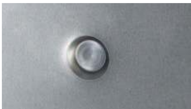
RISULTATO DELLA POSA DI UN RIVETTO AUTO-PERFORANTE
