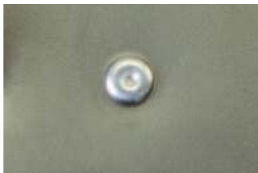
RESULTAAT VAN EEN FLOW FORM PONSNAGELVERBINDING.
