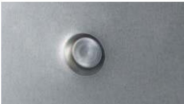
AFBEELDING PONSNAGEL VERBINDING VOOR- EN ACHTER-ZIJDE
